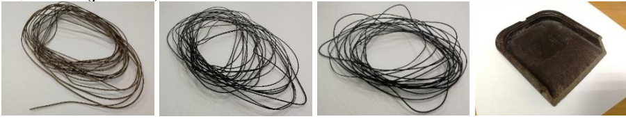
Рис. 13. 3D-нити, содержащие древесный наполнитель, высушенный при 130 °С (а), термически обработанный при 200 (б) и 240 °С (в); б – опытный образец подложки (г)
